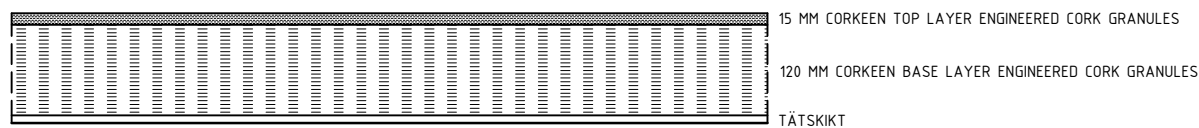
CORKEEN PLAY PÅ BJÄLKLAG, FALLHÖJD 2,8 M SKALA 1:10
